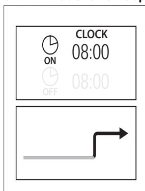
Эта функция нужна, чтобы кондиционер автоматически начал работать в установленное время, когда Вы возвращаетесь домой или желаете прийти в помещение, где уже достигнуты желаемые параметры воздуха.
